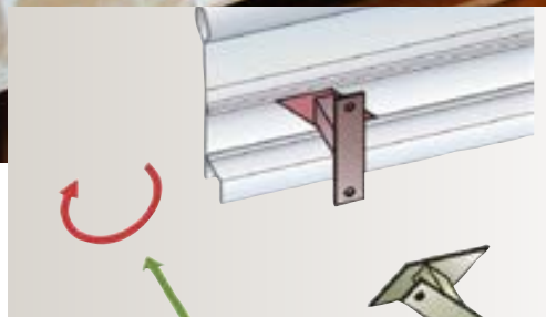
Suspension rapide du cadre à ses supports, et verrouillage par rotation à 45 degrés de la pièce de jonction.
