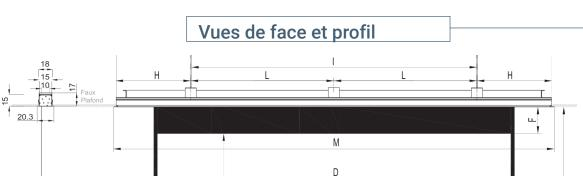
Base image Hauteur image Hauteur drop Longueur barre de charge Position idéale des fixations Position idéale de la 3<sup>ème</sup> fixation (écran de 3m et +) Entraxe des fixations variable Longueur hors tout sous face
