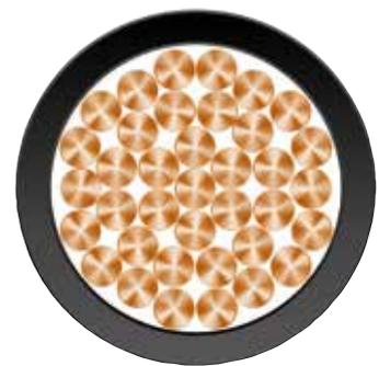
Une âme souple est composée de multibrin habituellement en cuivre. Les câbles équipés d'une âme souple supportent mieux la flexion que les câbles composés d'une âme monobrin.
