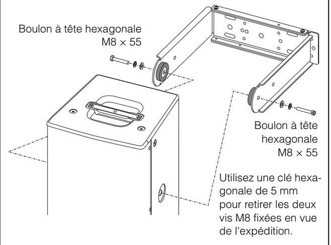
5. Ajustez l'orientation de l'enceinte, puis serrez les boulons de sorte que l'enceinte soit solidement fixée. Le couple de serrage recommandé est de 12,4 Nm.
