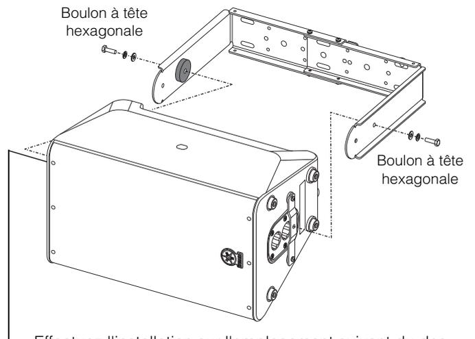
Effectuez l'installation sur l'emplacement suivant du dessus de l'enceinte.
