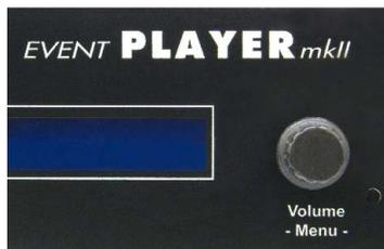
Lorsque le lecteur est en mode normal (c'est à dire sans être dans un menu de configuration), la rotation du bouton règle le volume de sortie.
