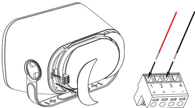
Veillez à ne pas croiser les fils lors de l'installation de vos enceintes. Le câblage doit toujours être négatif sur négatif et positif sur positif.
